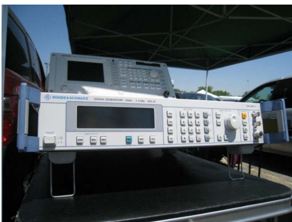
Årets bidrag till min samling av Rohde & Schwarz- instrument på Dayton: en SML 01, en klart trevlig signalgenerator för AM/FM/PhiM och pulsmodulering, med bra egenskaper från 9 kHz till 1 GHz. Finns i versioner upp till 3 GHz.
