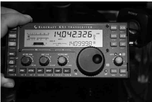
Elecraft KX3, årets stora nyhet på Hamvention. Här ser man storleken ganska väl. Data; 0,1 - 10 W. (100 W med KXPA100 amp 160-6m. SSB, CW, Data, FM, AM. Mått W=188, H=86, D=43 mm.
