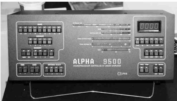
Alpha 9500 slutsteg med 3CX1500B/8877
