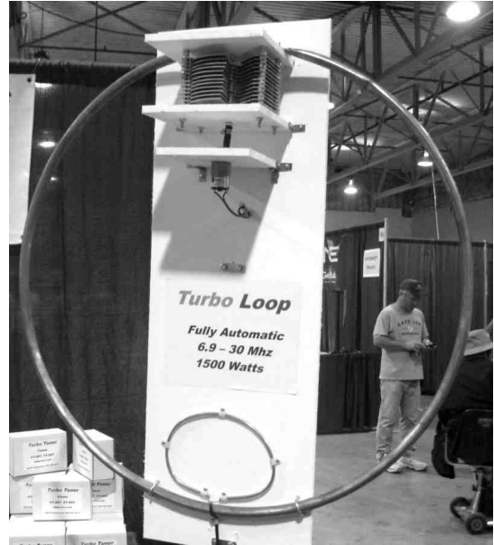
Turbo loop för HF från N2VZ Enterprises. 1500 W! Något för den trångbodde...
