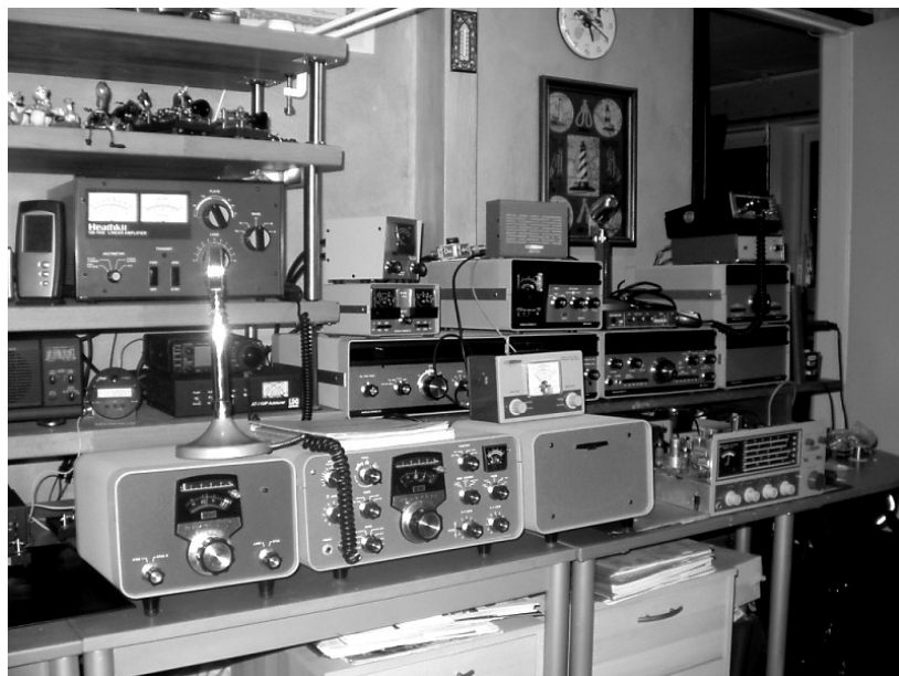
I Jannes shack väntar de gröna apparaterna på att användas. I frontraden syns en SB-102 transceiver och en HR-10B mottagare. Mottagaren är under trimning. I bakgrunden syns en komplett SB-104-line.
