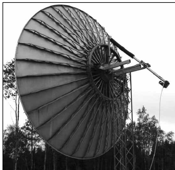
En rejäl aktuator-skruv från SVT sköter elevationen som mäts med en inklinometer.
