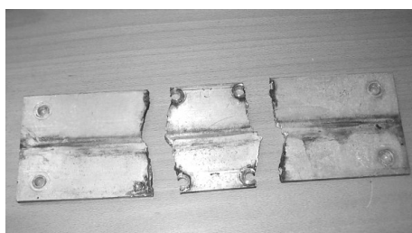
Fästplattan till 10 MHz-antennen sprack på två ställen.
