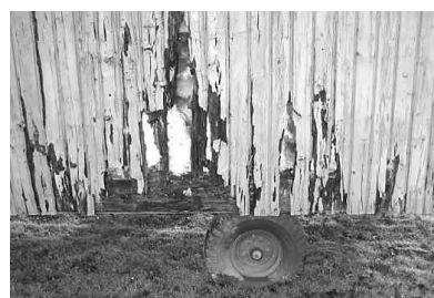
Kraftiga rötskador på den gamla vagnen
