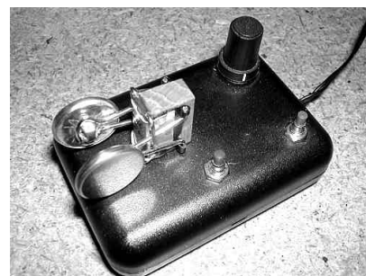
Manipulator "Bulldog" från K9LU. Minnesbugg byggd efter DL4YHF:s konstruktion (låda 55*80mm) (UGO)
