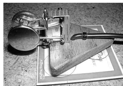
"Bulldog". Byxknapp, modifierad pappersklämma, träbit och två mässingsremсор. (UGO)
