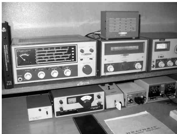
HR-10 mottagare och DX-60 sändare med VFO HG-10 i mitten, Underst HW-8 QRP-transceiver.
