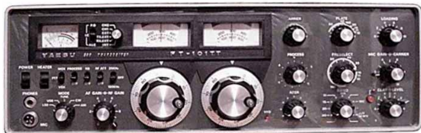
En av de mera ovanliga skapelserna på RigPix. En prototyp; FT101-TT från 1979. AM: 200 W (input) SSB: 960 W (PEP input) CW: 500 W (input)
