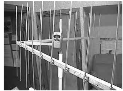
10 dB gain påstås det. "Cornerantenn" med en Telcom som drivelement!
