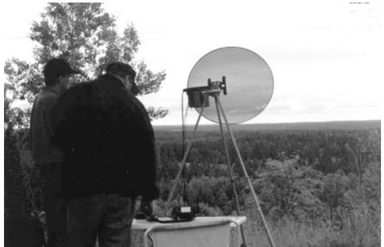
Här körs Gotland på SSB med god signalstyrka. Utrustning: Parabol 60cm (TV-satellitant), hemmabyggt matarehorn 8dB, Transverter enl DB6NT - 500mW - 4,5-5 dB brusfaktor. Anslutet till allmode 2m- stn (IC706)
