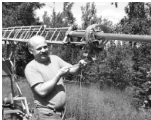
Magnus -TWP demonstrerar handrotorn som han har konstruerat till portabelmasten. Med linan kan man från marken rotera antennena.
