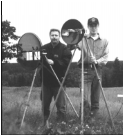
Ronny -FWZ och Mathias -VCW sköter kommunikationen på 10GHz. Kompass är ett måste för att sikta in sig.
